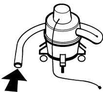
Очистите внутреннюю часть источника тока сжатым абсолютно сухим воздухом или вакуумом.
