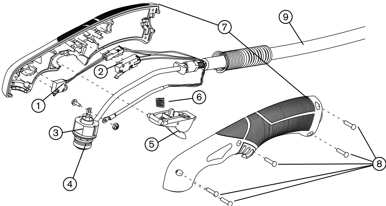
Можно заменить весь узел ручного резака и провода, или заменить отдельные компоненты резака.
