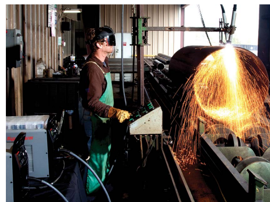
Резка труб и косые срезы
